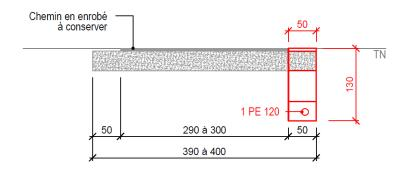
Figure 4 : schéma d'implantation des câblages souterrain en bordure des chemins en enrobé existants (source : ATB SA).
