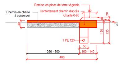
Figure 1 : principe d'élargissement et de remise en état des chemins en chaille existants (source : ATB SA).
