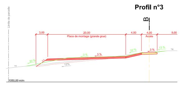
Figure 7 : exemple de restitution d'une place de montage avec démantèlement partiel du coffre (T2). Le terrain remis en état est représenté par la ligne verte. (source :ATB SA).
