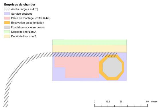
Figure 5 : schéma de principe d'une place d'installation de chantier (extrait du plan de situation de l'éolienne T5, source ATB).
