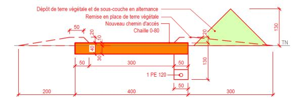
Figure 2 : principe d'aménagement et de remise en état des nouveaux accès (source : ATB SA).
