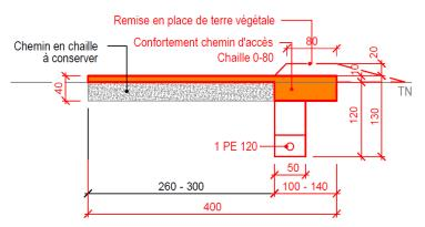
Figure 3 : implantation des câblages souterrains dans le coffre des accès en chaille existants (source : ATB SA).
