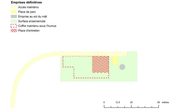
Figure 8 : schéma de principe d'une place d'installation de chantier restituée (extrait du plan de situation de l'éolienne T5, (source : ATB).
