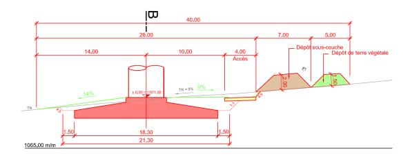
Figure 6 : exemple de remise en état sur le socle d'une éolienne (T1). Le trait vert correspond au niveau final du sol restitué (source : ATB SA).
